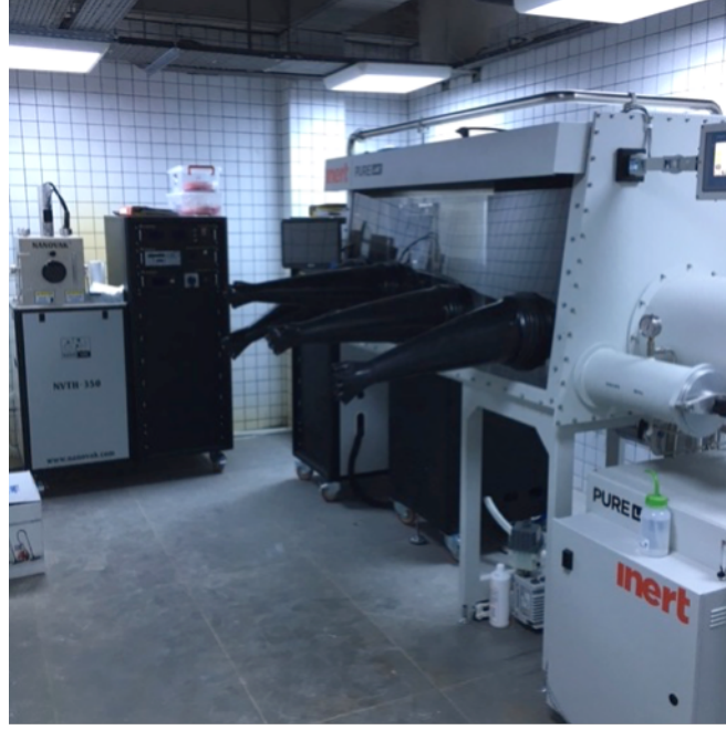
Şekil 97. AGÜ'ye kurulumu gerçekleştirilen Glove Box entgre OLED fabrikasyon sistemi (organik ve metal buharlaştırıcı) ve metal buharlaştırıcı sistemi
